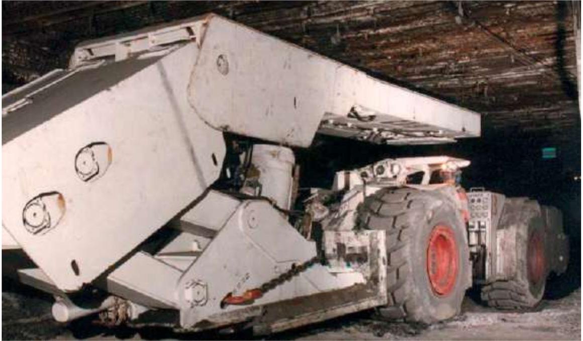
Рис. 34. Тягач TS350 SANDVIK перевозит секцию механизированной крепи
