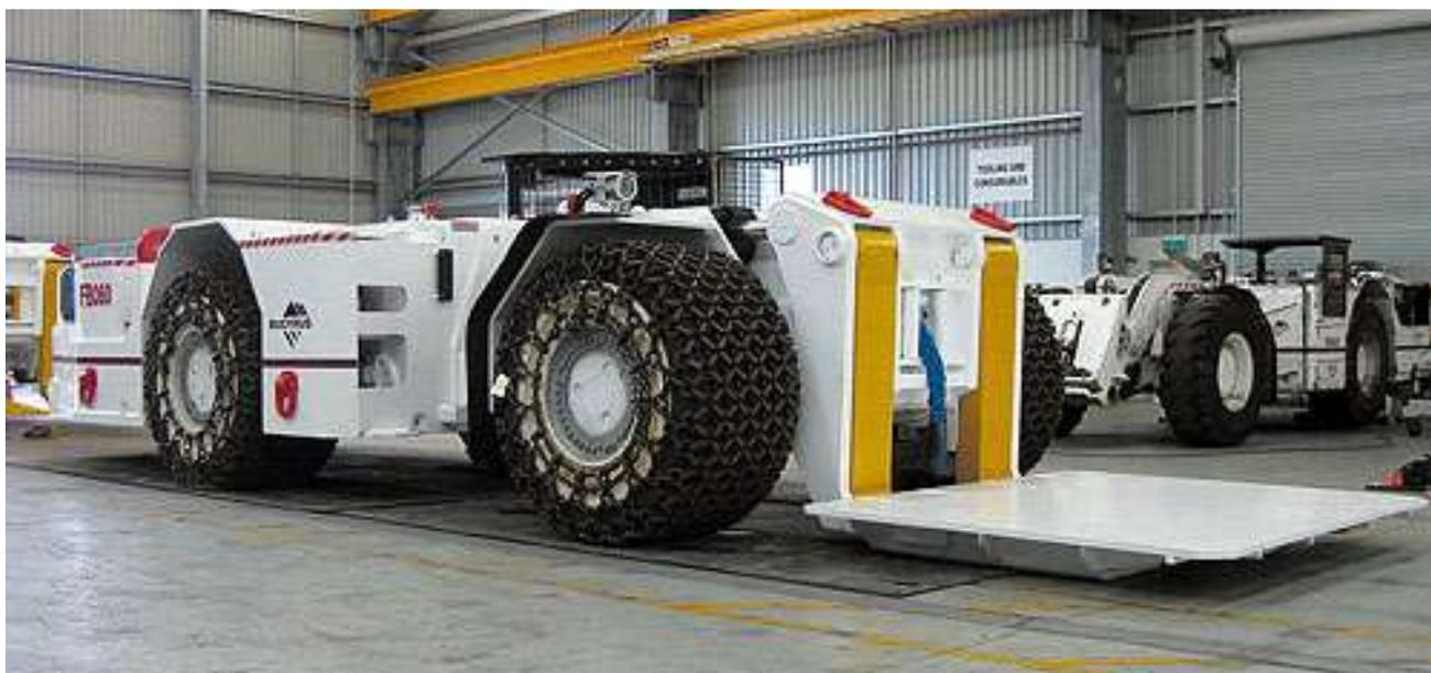
Рис. 24. Шахтный тягач с платформой FBL-55 / FBL-55 (H)
