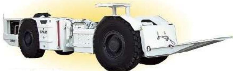
Рис. 44. Тягач серии PST 20S для перевозки секций крепи
