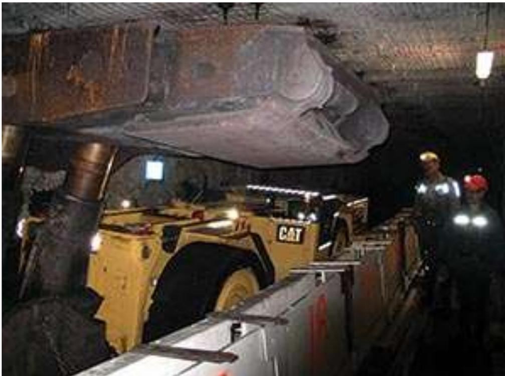
Рис. 20. Перевозчик секций крепи SH660 D в лаве
