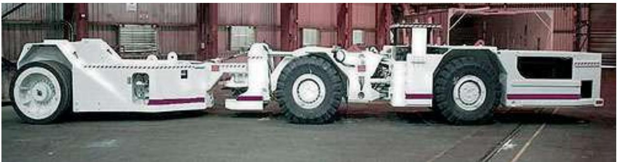
Рис. 29. Многофункциональная ПДМ с трейлером СНТ-50
