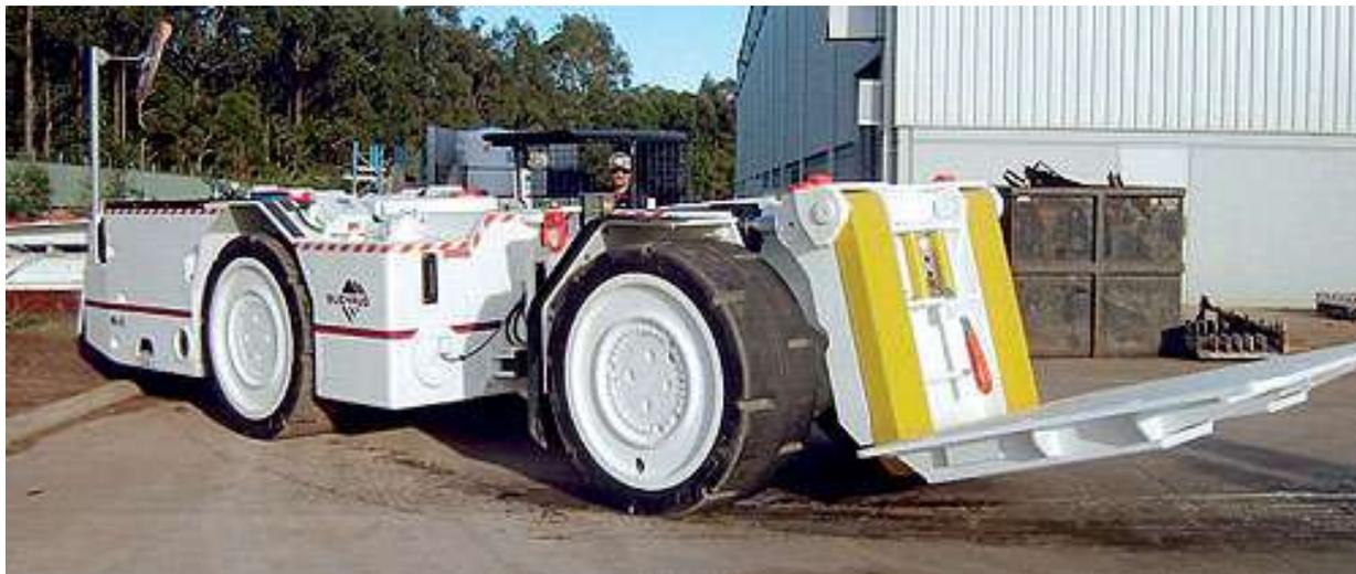
Рис. 23. Шахтный тягач с платформой МН-40
