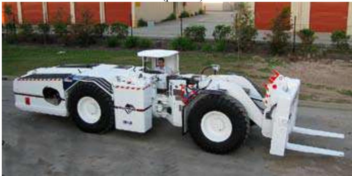
Рис. 26. Многофункциональная шахтная ПДМ «Компакт»
