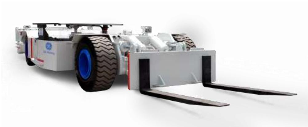
Рис. 51. Перевозчик крeпи с вильчатым захватом
