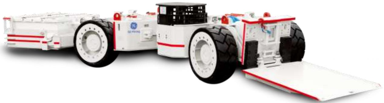
Рис. 50. Перевозчик крeпи 36С-АС (тягач с платформой)
