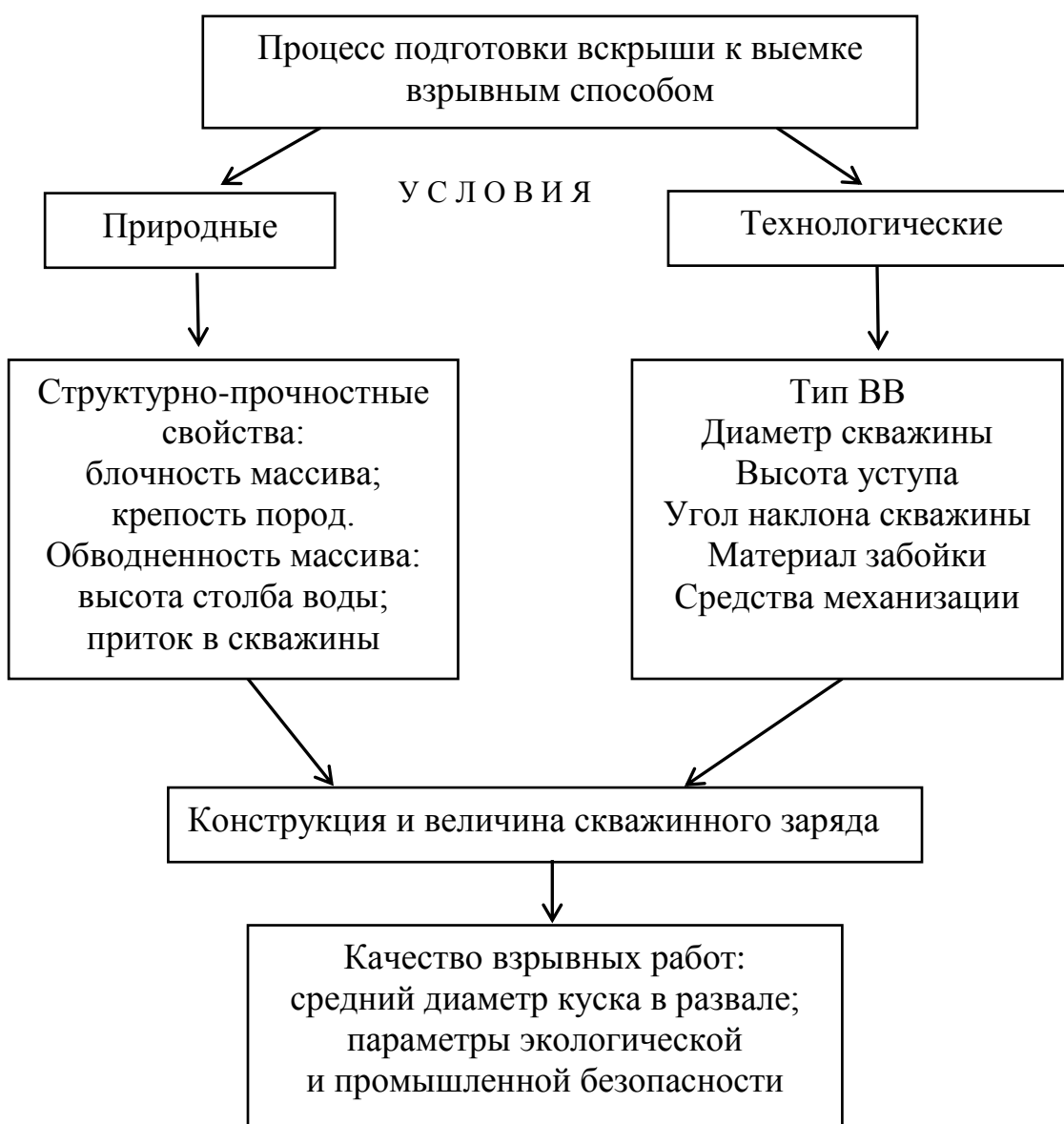
Рис. 5.1. Классификация элементов системы управления качеством взрывных работ
