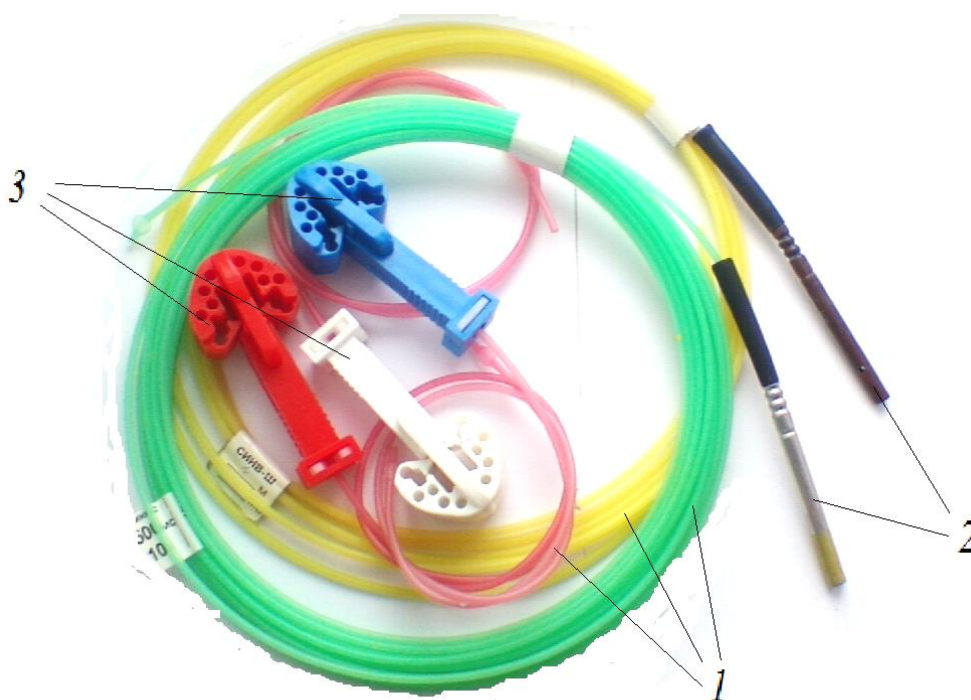
Рис. 7.8. Система инициирования Искра: 1 – волноводы; 2 – капсуль-детонатор Искра-С; 3 – монтажный блок Искра-П
