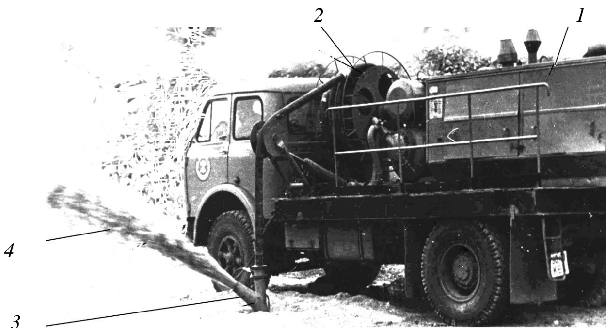
Рис. 6.6. Процесс удаления воды из скважин машиной МО-1: 1 – компрессор; 2 – шланг; 3 – водоотводящее устройство; 4 – вода
