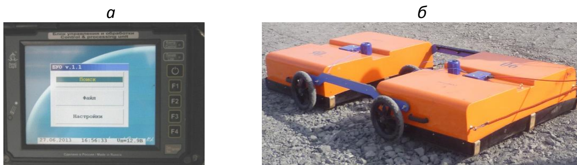
Рис. 1.3. Георадар ОКО-2: а – внешний вид БУО; б – антенный блок с центральной частотой 90 МГц
