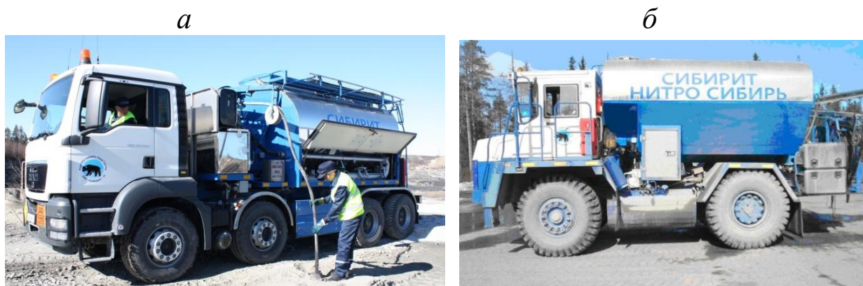
Рис. 4.6. Смесительно-зарядные машины: а – МСЗ-16; б – МСЗ-20
