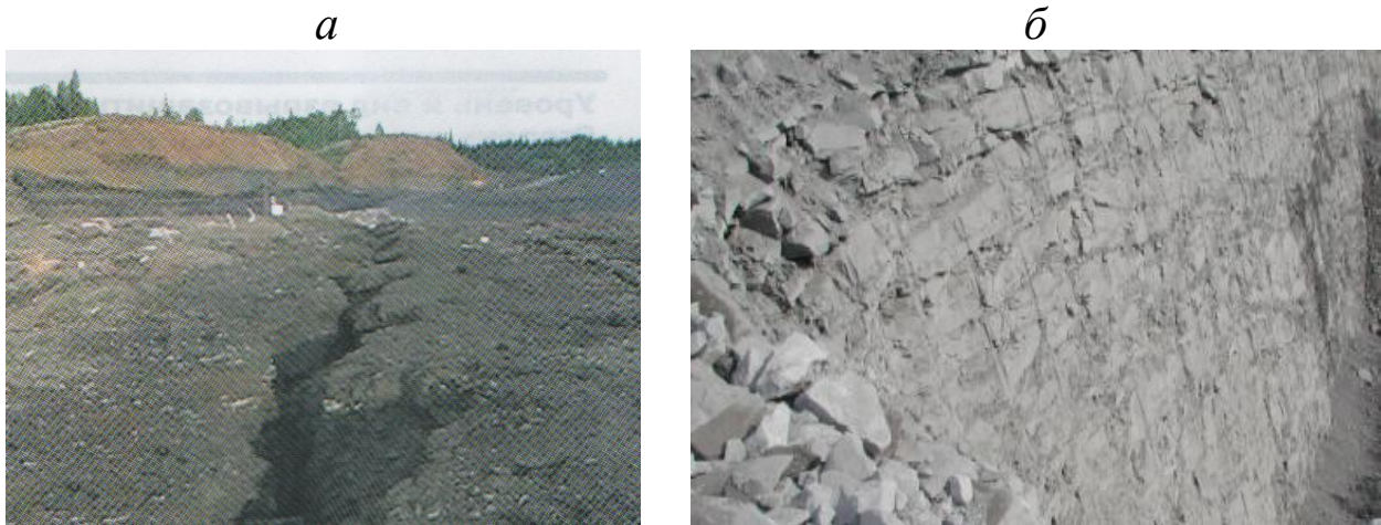
Рис. 6.3. Щель по линии контурных зарядов (а) и вид откоса уступа при использовании предварительного контурного взрывания (б)
