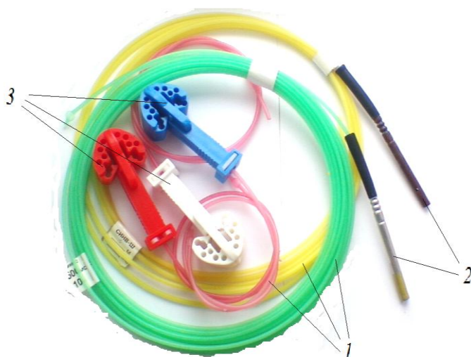
Рис. 5.8. Система инициирования Искра: 1 – волноводы; 2 – капсуль-детонатор Искра-С; 3 – монтажный блок Искра-П
