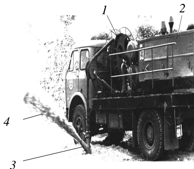
Рис. 6.10. Процесс удаления воды из скважин машиной МО-1: 1 – компрессор; 2 – шланг; 3 – водоотводящее устройство; 4 – вода
