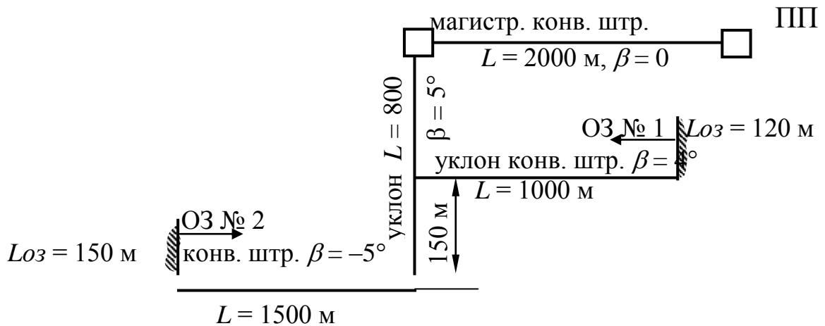
Рис. 1. Технологическая схема транспорта: а – участковая; б – участковая с магистральной выработкой; в – участковая с магистральной выработкой и аккумуляющим горным бункером
