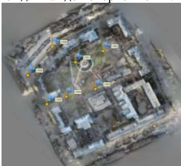
Рис. 37. Облако точек с размещенными маркерами
