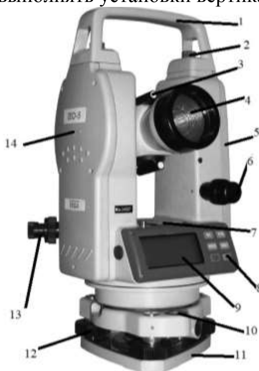
Рис. 23. Электронный теодолит ТЕО
