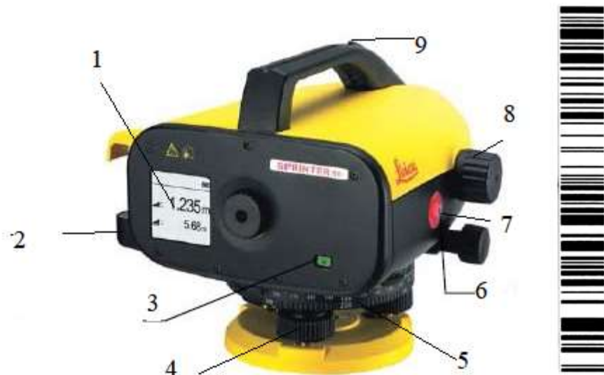
Рис.21.Электронный нивелир Leica Sprinter 50 и штрих-кодовая рейка (справа)
