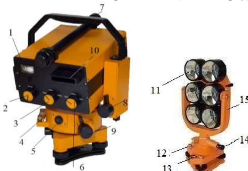
Рис. 16. Светодальномер СП-2 и шестипризмный отражатель
