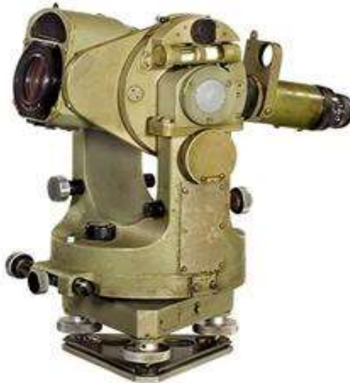
Рис. 11. Редуционный тахеометр Редта 002
