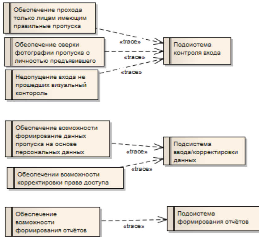
Рис.4.3 Разделение требований по функциональным подсистемам
