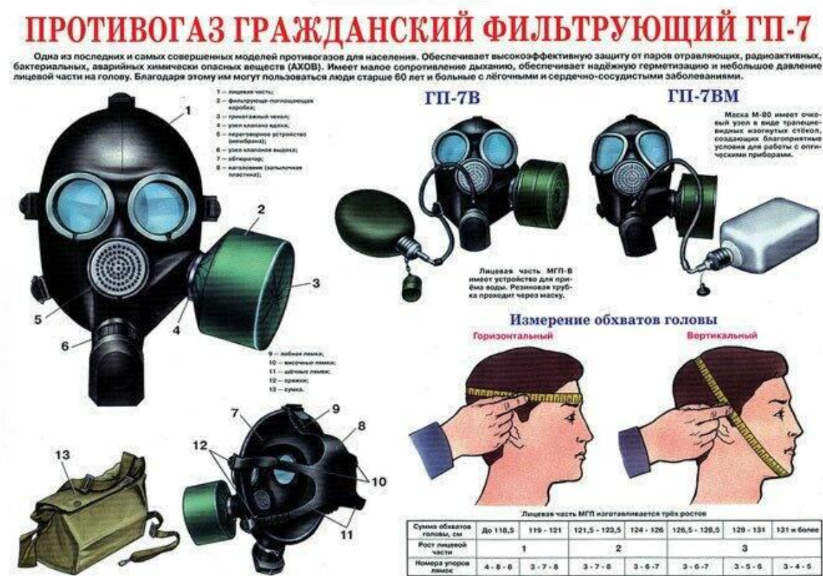
Рис. 22. Противогаз гражданский, фильтрующий ГП-7
