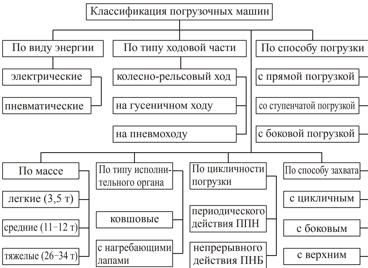
Рисунок 6.2 – Классификация погрузочных машин
