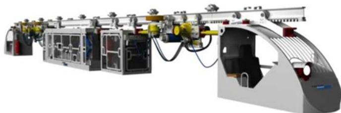
Монорельсовая зубчатая дорога BWBU-50/100 совместима с монорельсовыми дорогами других изготовителей, изготовленными из профиля П155. Для этого возможно изготовить переходные рельсы.
