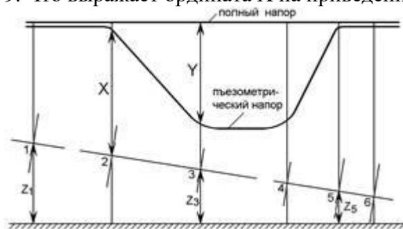
а) пьезометрический напор;
