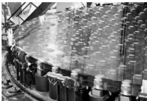
**Зеркало современного телескопа. Его формой управляет 261 актюатор.**
