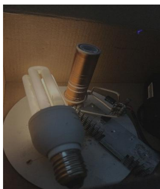
Рисунок 3 Передача энергии от катушки Тесла
