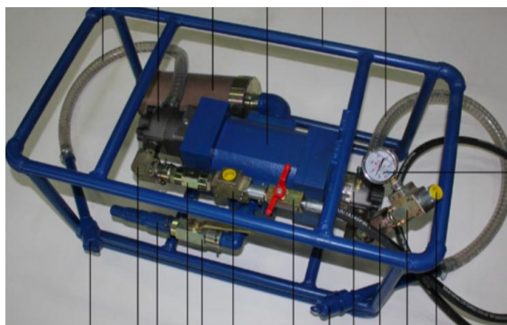
Рисунок 2 – Насос пневматический шестеренчатый типа НПШ.
