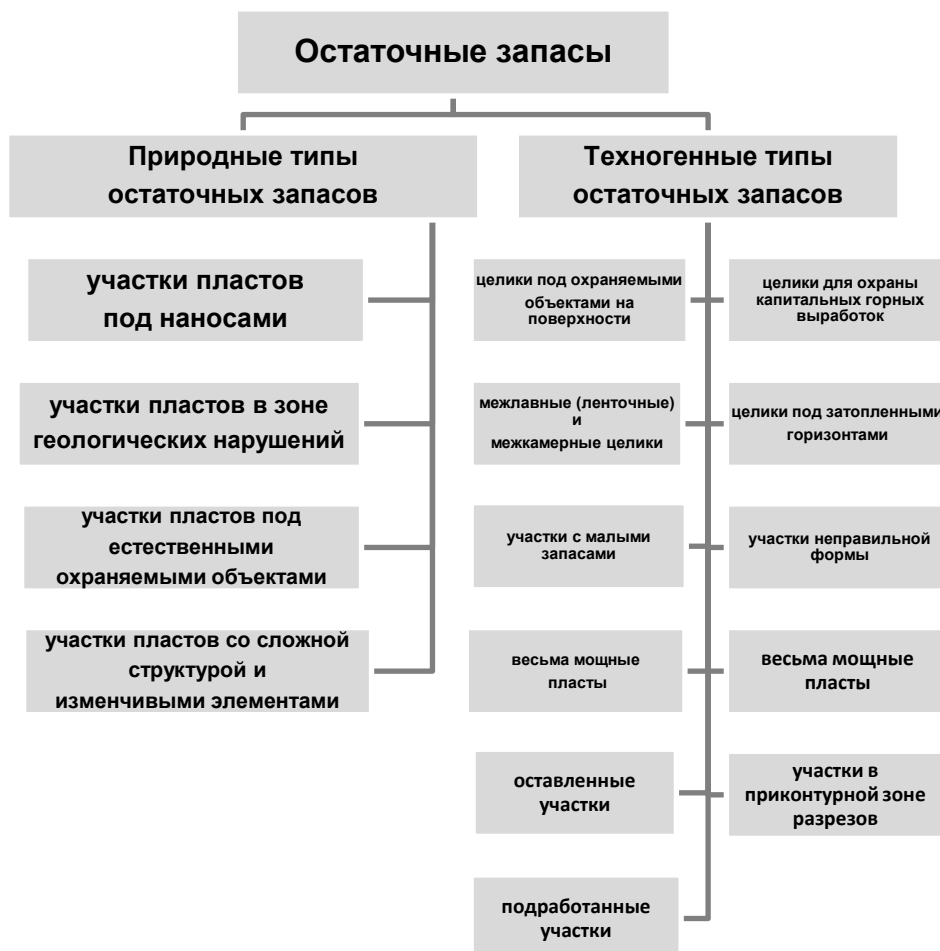
Рис. 1 – Классификация участков пластов с остаточными запасами угля.
