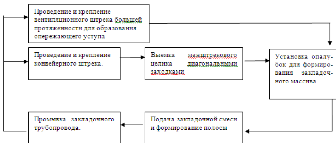
Рис. 2 Организация работ в подготовительных забоях
