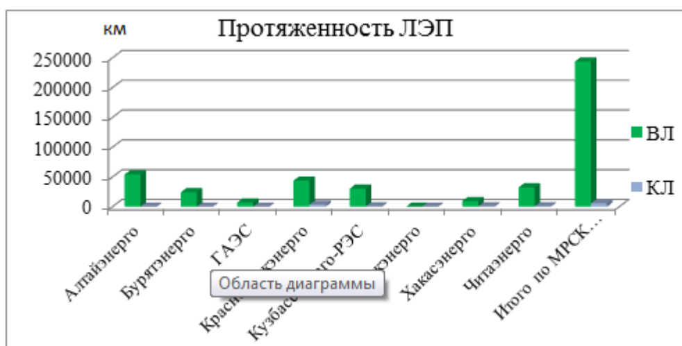
Рис.1. Протяженность ЛЭП по цепям ВЛ и КЛ
