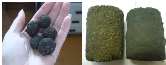
Рис. 2: Образцы топлива повышенной прочности и теплоты сгорания: а – гранулы, б – брикеты до и после процесса упрочнения пироуглеродом.
