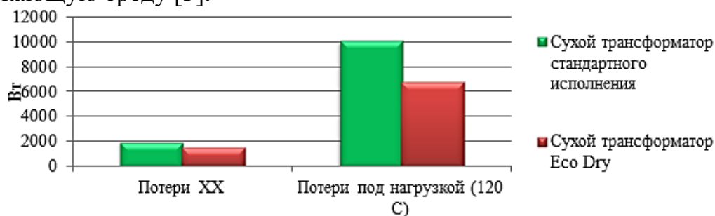
Рис.2. Сравнение потерь электроэнергии сухого трансформатора стандартного исполнения и сухого трансформатора серии Eco Dry 1000 кВА
