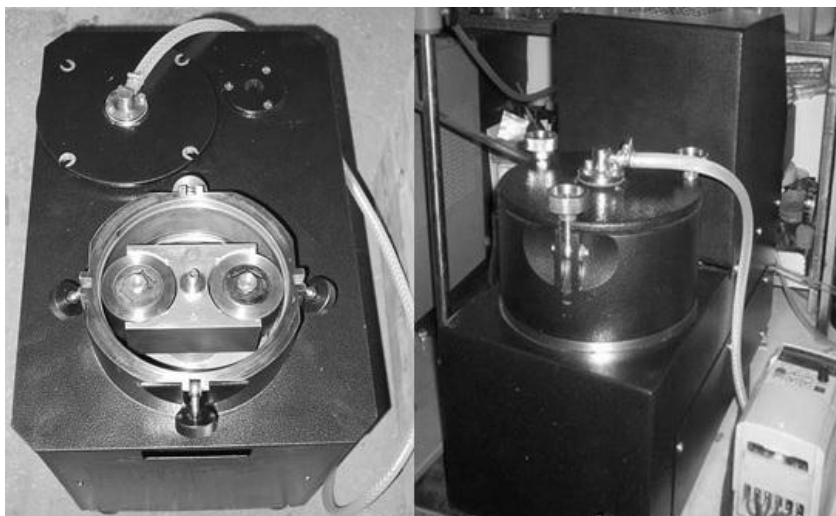
Рис. 2. Шаровая планетарная мельница АГО-2С
