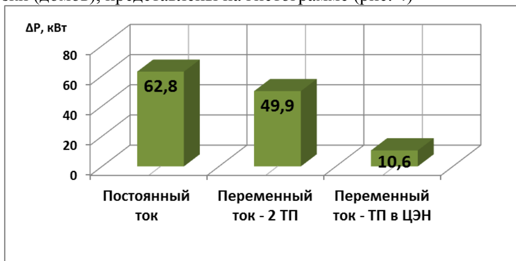
Рис. 4. Потери мощности в ЛЭП при трех вариантах электроснабжения
