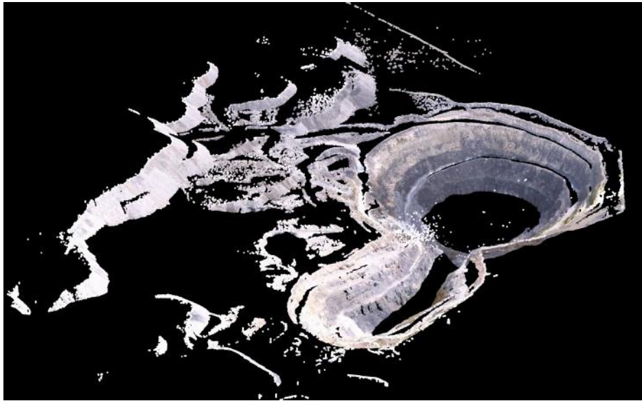
Рисунок 4 - Трехмерная модель карьера «Восточный» месторождения Акжал
