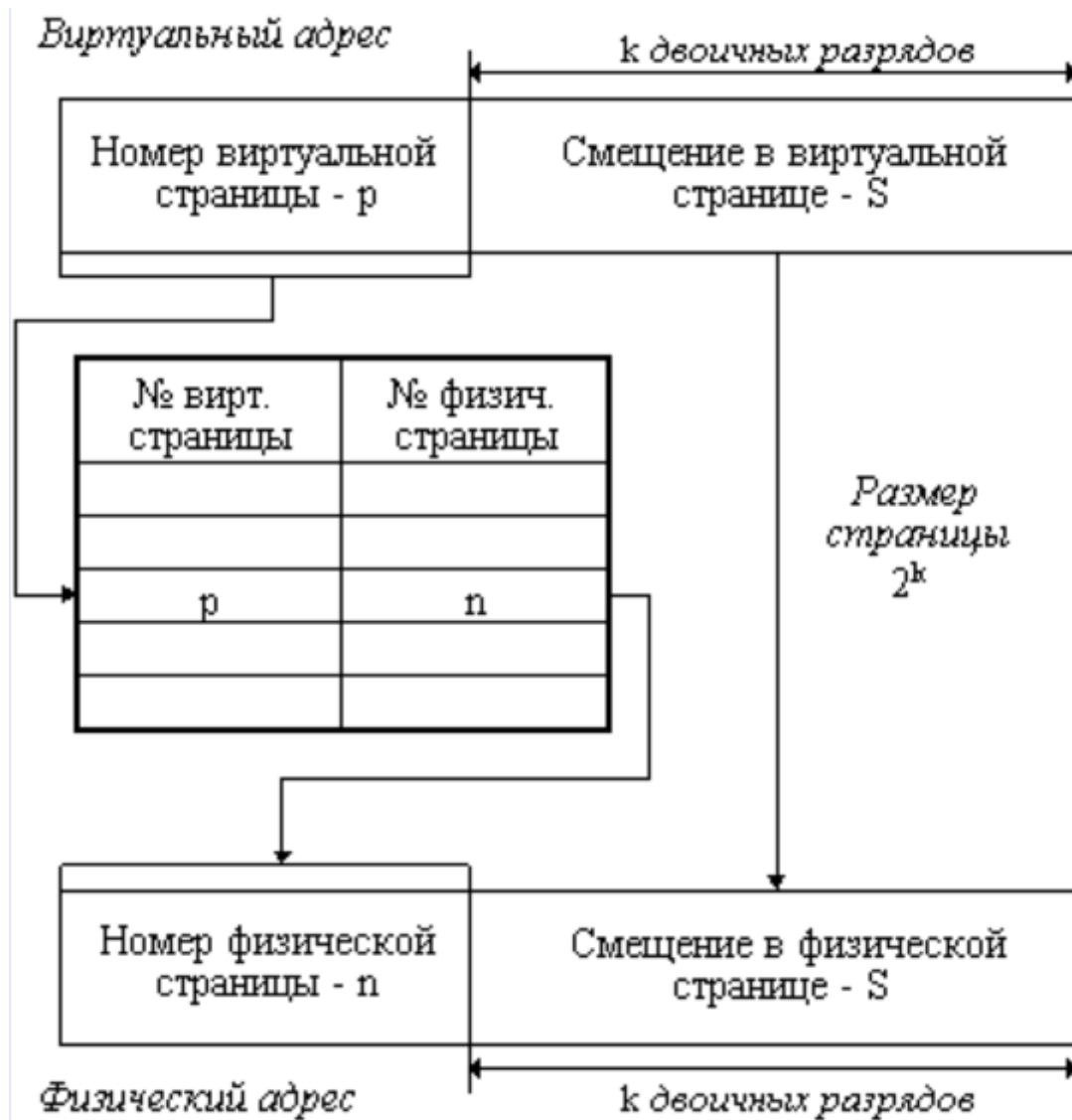
Рисунок 13 – Механизм преобразования виртуального адреса в физический при страничной организации памяти
